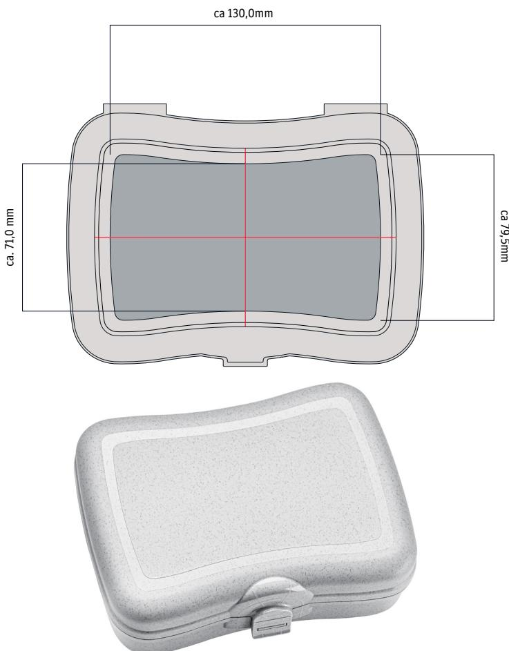
Wir weisen darauf hin, dass die unterschiedlichen Farben als Hinweis auf unterschiedliche Oberflächenstrukturen dienen können, außer der Farbton ist explizit aufgeführt.
